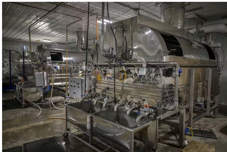
グッドリッチ・ファームの最新の樹液加熱装置。90%以上の水分を除いた樹液を、蒸気を利用して素早く熟する
